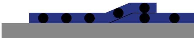
图6a: 重叠接缝
