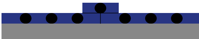
图4b: 边到边平接缝
